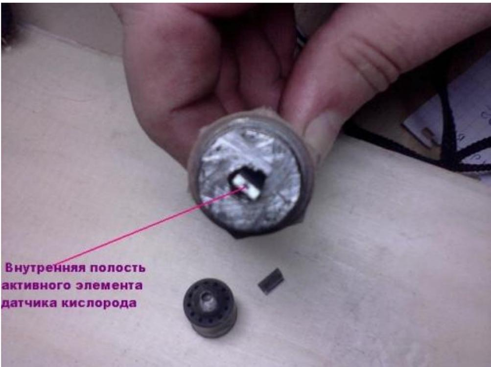
Поискав по гаражу подходящие шланги, и перерыв коробку со штуцерами, находим вроде бы нужные. Приходит решение сунуть резьбовую часть в подходящий шланг. Так как на прямоугольный элемент ничего герметично не наденешь, а сам элемент надежно отделен от верхней части. А там дым из дым машины найдет себе выход.
