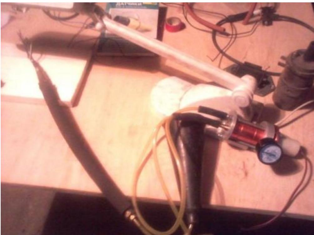
Ну вот... и момент истины. Затаив дыхание смотрим. При подаче дыма под давлением, несмотря даже на малое сечение отверстия в керамическом элементе, «колечко скрутки» проводов даже подергивается. И вот... дым пошел с концов проводов!!! Этого не может быть, но это так.
