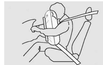
При сильном ударе по автомобилю с передней стороны подушки безопасности быстро раскрываются, защищая лицо, голову и грудь водителя и пассажира. При срабатывании модуля подушек безопасности раздается хлопок и выделяется дым или пыль белого цвета.
