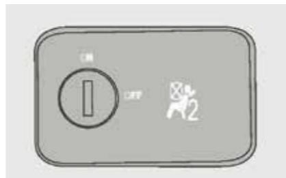
Выключатель модуля подушки безопасности со стороны пассажира.
