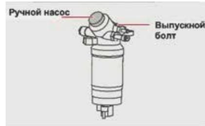
При опустошении топливного бака в топливную систему попадает воздух. В результате попадания воздуха возникают перебои в подаче топлива в двигатель. Во избежание связанных с этим отказов и неполадок необходимо стравить воздух из топливной системы.
