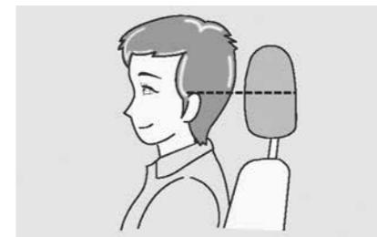
Если рост пассажира слишком высокий, и диапазон регулировки не позволяет установить подголовник на уровне глаз, он просто поднимается на максимальную высоту.
