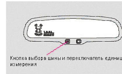
Кнопка выбора шины и переключатель единиц измерения
