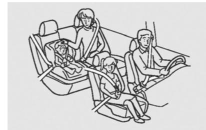
В зависимости от комплектации автомобиля передние кресла могут быть оборудованы ремнями безопасности с механизмом предварительного натяжения или без этого механизма. На модели автомобилей с одной подушкой безопасности устанавливаются обычные ремни безопасности, в то время как на автомобилях с двумя подушками безопасности устанавливаются ремни безопасности с механизмом предварительного натяжения.
