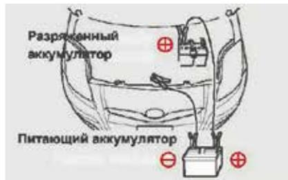
Если аккумулятор сильно разряжен, можно запустить двигатель, подсоединив кабели к исправному аккумулятору на другом автомобиле. Не следует пытаться запустить двигатель с толчка или на буксире, так как это связано с риском повреждения трехэлементного каталитического преобразователя и других устройств и частей автомобиля.
